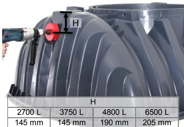
Die Zu-, Ablauf und Verbindungsleitungen an den Halbschalen mit einem Kronenbohrer DN 100 bohren ( $\varnothing$  124 mm).
