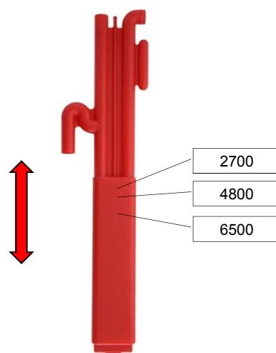
Die Länge des Hebers muss je nach Tankgröße durch verschieben des Heberschuhs angepasst werden. Die ungefähre Position ist auf dem Heber angegeben. Die exakte Höhe ist im Behälter zu bestimmen.
