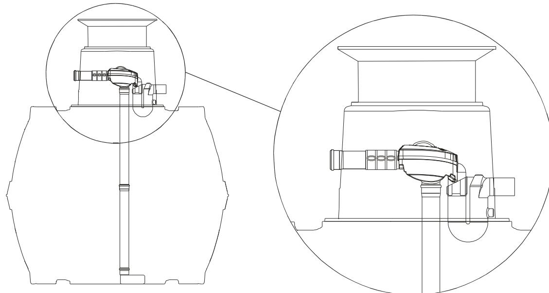
Colocar el filtro preparado con la zapata de entrada tranquila en el tanque. Instalar el desagüe del filtro en el sifón y conectar el tubo de alimentación con la entrada del filtro mediante un manguito de sujeción por tensor Spannfix (contenido en el Pack filtración 3).
